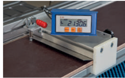
Integrierte Schneidvorrichtung sowie Messsystem Integrated cutting device and measuring system
