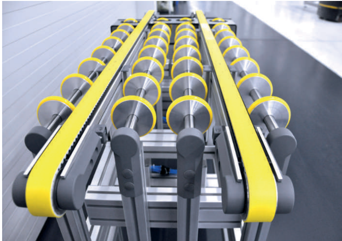
Hub-Quer-Förderer für Flächenelemente Lifting cross conveyor for panel elements
