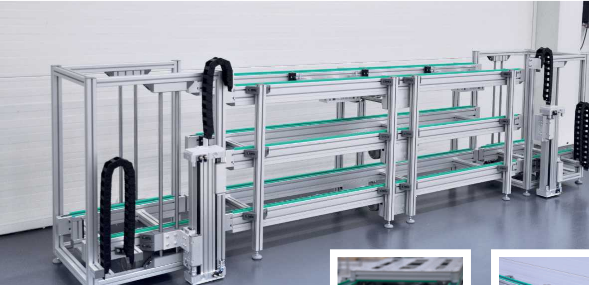
Werkstückträgersystem mit Lift auf 3 Ebenen Workpiece carrier system with lift on 3 levels
