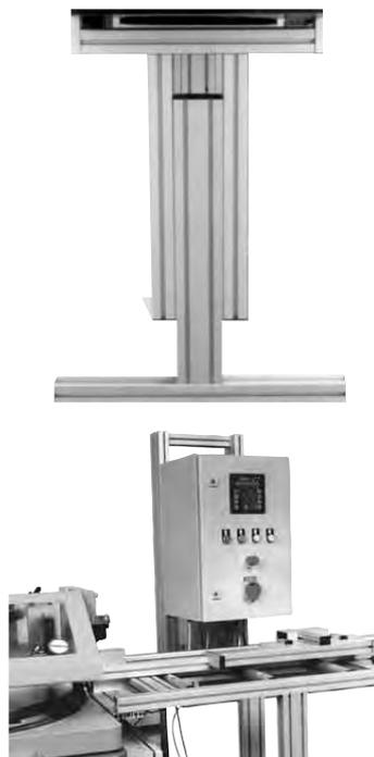
Nos butées longitudinales MiniTec sont des solutions complètes éprouvées. Elles sont composées d'éléments standards de notre système de profilé MiniTec et permettent donc une grande modularité de l'ensemble. Toutes les butées longitudinales sont équipées d'une plaque de pieds avec réglage en hauteur et avec des perçages pour fixation au sol. Il est également prévu une plaque intermédiaire avec des perçages pour fixation à la machine.
